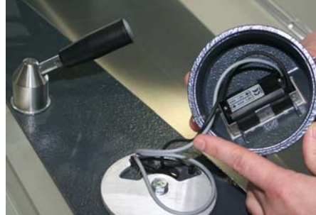
Gehäuse mit Anzeige-Elektronik entnehmen
