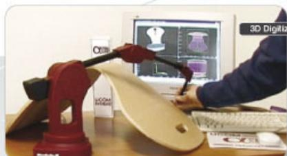
Digitizzatore 3D completo di interfaccia di comunicazione per Alpha CAM
