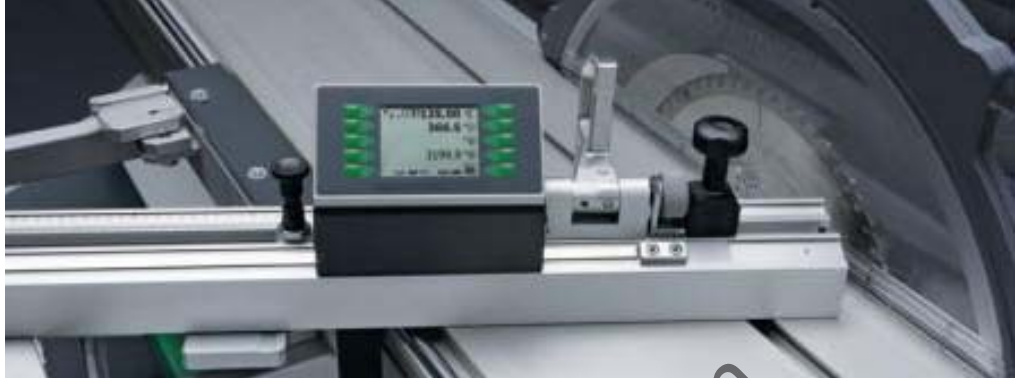
Fig. 6-78 Crosscut-mitre fence display unit WGA_LD
